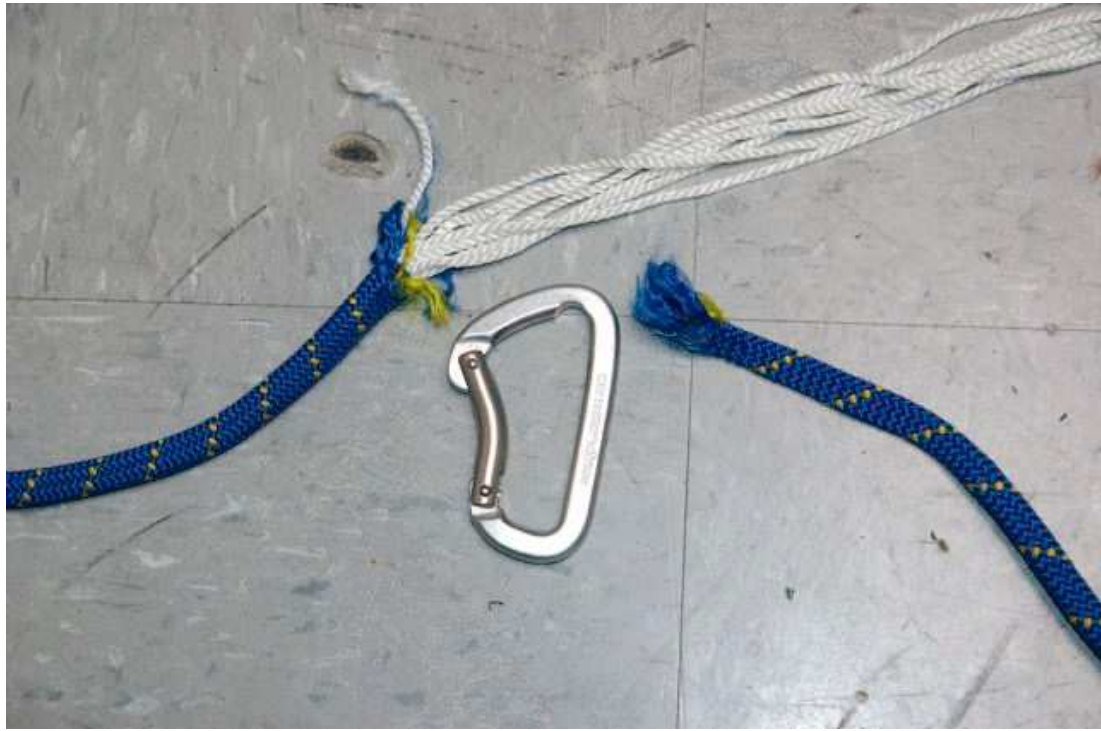
Dieser eingeschliffene Fixkarabiner aus einer Sportkletterroute hat das fabrikneue Seil in einem Test zerschnitten. Bild: blackdiamondequipment.com
